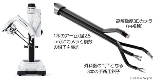
アームには直径2.5cmの筒の中に、3Dカメラ(内視鏡)と3本の鉗子(外科医の手に相当。通電可能な電気メスなども含む)が集約されており、これを体腔内に挿入して手術を行います。最少で お臍の傷(2.7cm)だけで手術ができ、痛みが減り負担も少ない低侵襲手術が可能になります(腫瘍の大きさや部位によっては、安全確保のため1~2つのポート孔
